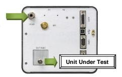
Il regolatore meccanico frontale ha la funzione di regolare il flusso d'aria in ingresso proveniente da IN AIR
