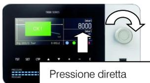
Stessa cosa avviene per gli strumenti "prova di portata" con l'unica differenza che la regolazione della pressione avviene in qualsiasi fase di test.
