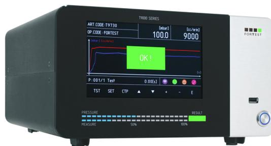
La T9731 - EN 14683 è realizzata allo specifico scopo di misurare la adeguata portata di aria in completa aderenza alla norma EN 14683 alla quale si fa costante riferimento.
